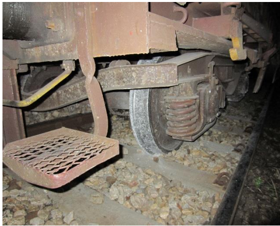
Слика 3.4.4.1: Изглед дела исклизлог обртног постоља
